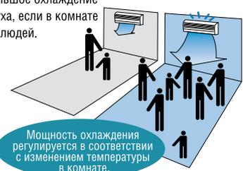
Мощность охлаждения регулируется в соответствии с изменением температуры в комнате.
