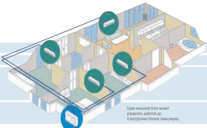
Один внешний блок может управлять работой до 4 внутренних блоков (максимум).
