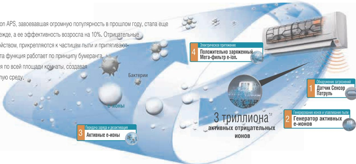
\*1 Для кондиционера воздуха с системой очистки воздуха, испускающего отрицательные ионы с помощью генератора для передачи отрицательного заряда частицам пыли и притягивания их ко всей поверхности положительно заряженного фильтра (по состоянию на ноябрь 2007 г.).
