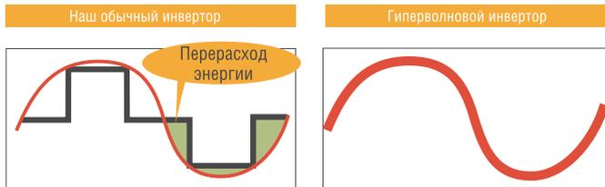
Кривая процесса отклоняется от кривой напряжения на двигателе, отсюда – перерасход энергии.
