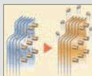
При сильном запахе, а также до и после сезона кондиционирования теплообменник нагревается и уничтожает неприятные запахи.
