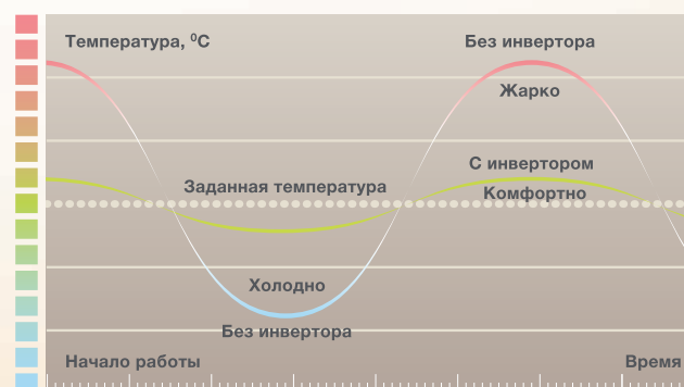
Схема работы DC инвертора
