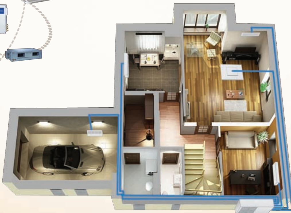
Схема работы мульти сплит-системы Super Match
