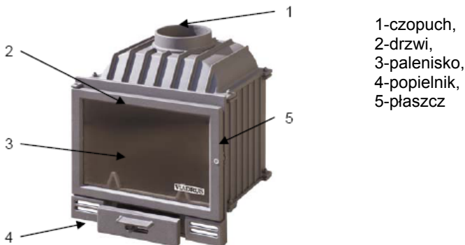
Rys nr. 1 Podstawowe elementy wkładu kominkowego
